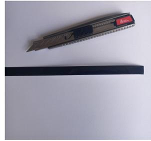
Schneiden Sie das benötigte Edge Sealing Tape ab (fügen Sie 2-3 cm zur Länge hinzu)
