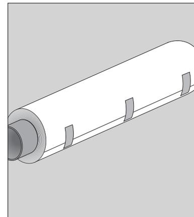
Sollte Gewebe übrigbleiben, wird empfohlen, die Originalverpackung zu verwenden. Squid® eng auf den Wickelkern aufwickeln und mit 3 Klebestreifen straff fixieren (links aussen, in der Mitte und rechts aussen).
