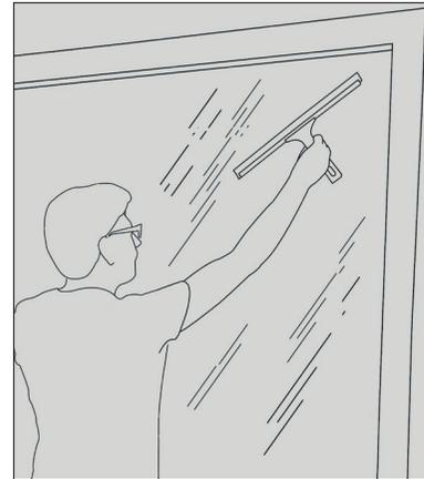
Fenster gründlich mit Wasser und Ammoniak oder alkoholhaltigem Putzmittel reinigen und entfetten. Fenster mit einem fusselfreien Tuch trocknen, damit keine Rückstände bestehen bleiben.
