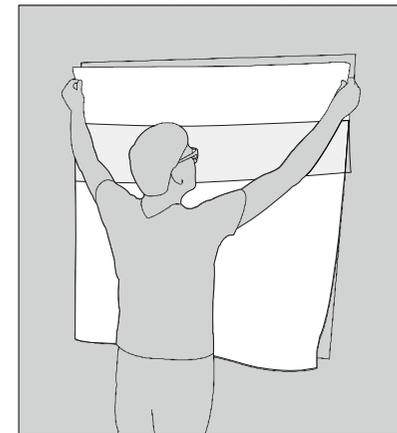
Squid® oben am Fenster anbringen und mit leichtem Druck auf die Glasfläche andrücken. In ca. 15 cm Abschnitten die Trägerfolie von oben nach unten abziehen und Squid® jeweils von der Mitte aus, nach aussen auf das Glas streichen.
