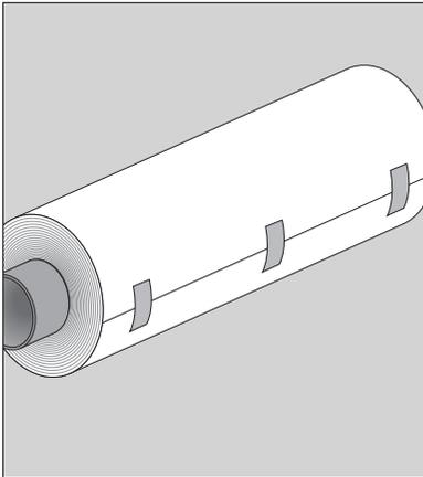
Squid® sollte bis zur Installation auf dem Wickelkern eng aufgewickelt bleiben. Wir empfehlen drei straff angebrachte Klebestreifen zur Fixierung des Produktes, gleichmässig verteilt, links aussen, in der Mitte und rechts aussen, damit sich der Stoff nicht frei bewegen kann.
