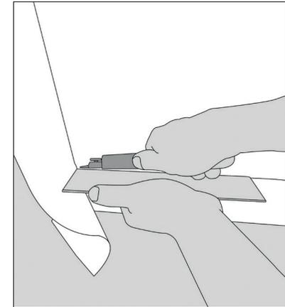
Platzieren Sie die Raker über der Silikonfuge, damit Sie das überstehende Gewebe sauber mit dem Messer (Cutter) wegschneiden können. Der Schnitt sollte durch einen gleichmässigen Druck und einem scharfen Winkel erfolgen.
