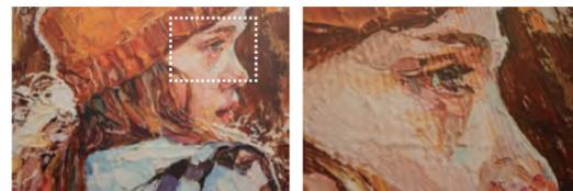
Erzeugt automatisch Texturschichtdaten aus grafischen Informationen in RasterLink7. Bei diesem Prozess wird die UV-Tinte in Schichten aufgetragen, um strukturierte Effekte zu erzeugen, wobei dickere Schichten zu ausgeprägteren Erhebungen und Vertiefungen führen.
