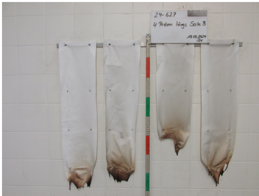
Bild 2: Aussehen der Proben nach dem Brandversuch
