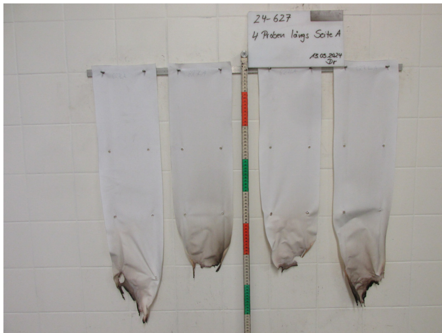
Bild 2: Aussehen der Proben nach dem Brandversuch
