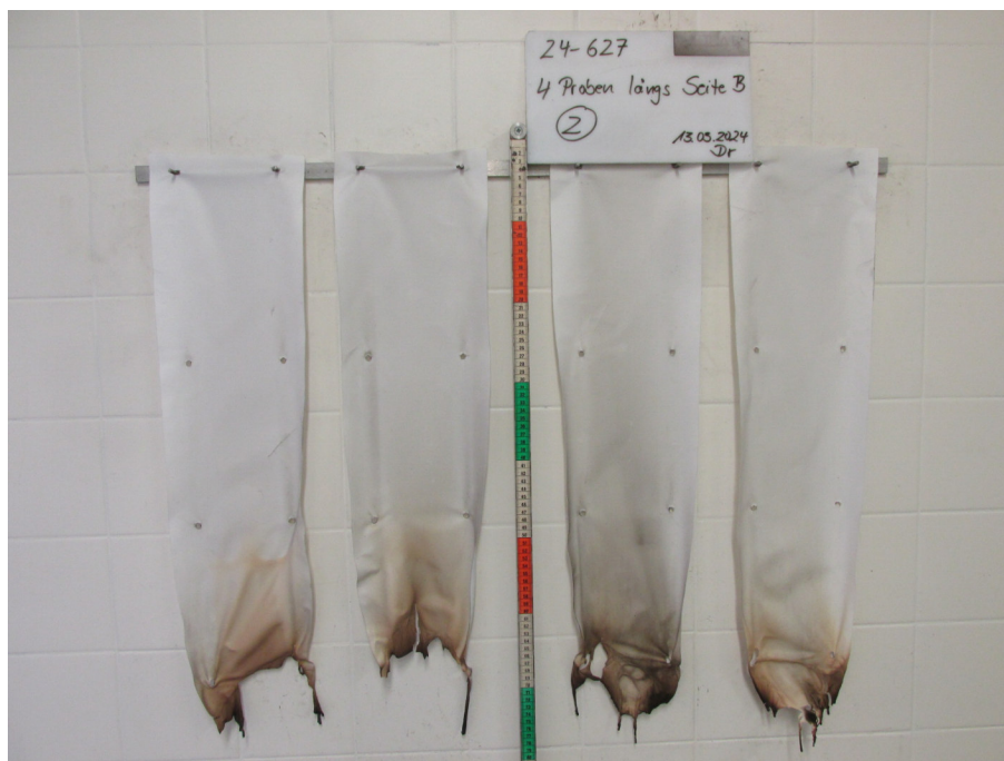
Bild 2: Aussehen der Proben nach dem Brandversuch
